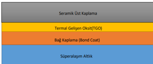
Şekil 3. Termal bariyer kaplama katmanları[2]
