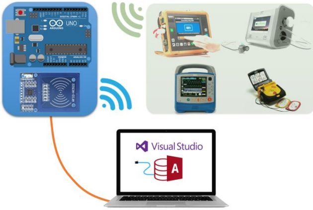
Şekil 1. Önerilen IoMT-tabanlı RFID tıbbi cihaz anamnez sisteminin genel yapısı
